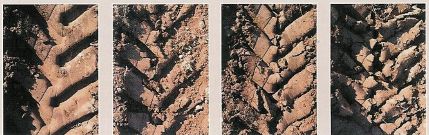
Die Spur zeigt den Schlupf (von links): null Prozent, zehn Prozent, 20 Prozent und 30 Prozent
