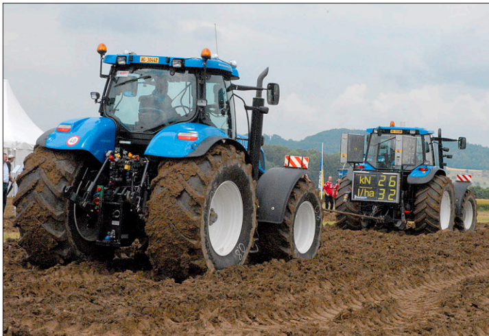
Der Traktor vorne zog den hinteren Traktor einmal mit 1,6 bar und beim zweiten Mal mit 0,7 bar Reifenluftdruck. (Bilder: röt)
