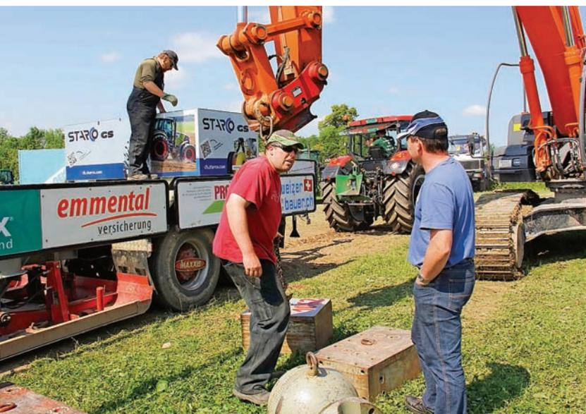
Hier wird mit schwerem Stahl das schiebbare Gewicht aufgelastet. Bei schweren Traktoren können bis 8,5 Tonnen zugeladen werden.
