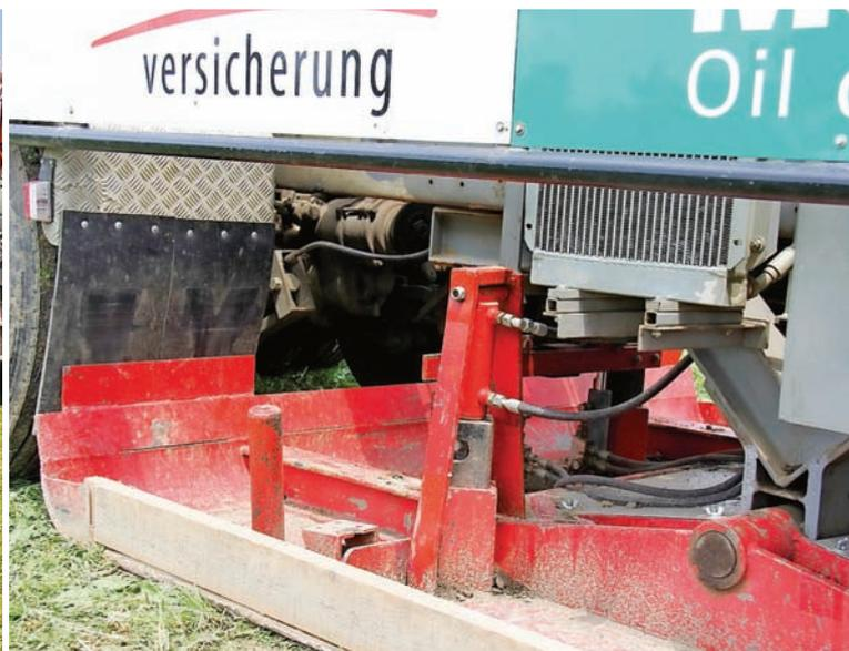
Die Bremskufe ist für zusätzliches Bremsen mit Scharreisen ausgerüstet. Sie werden distanzabhängig in den Boden gerammt.
